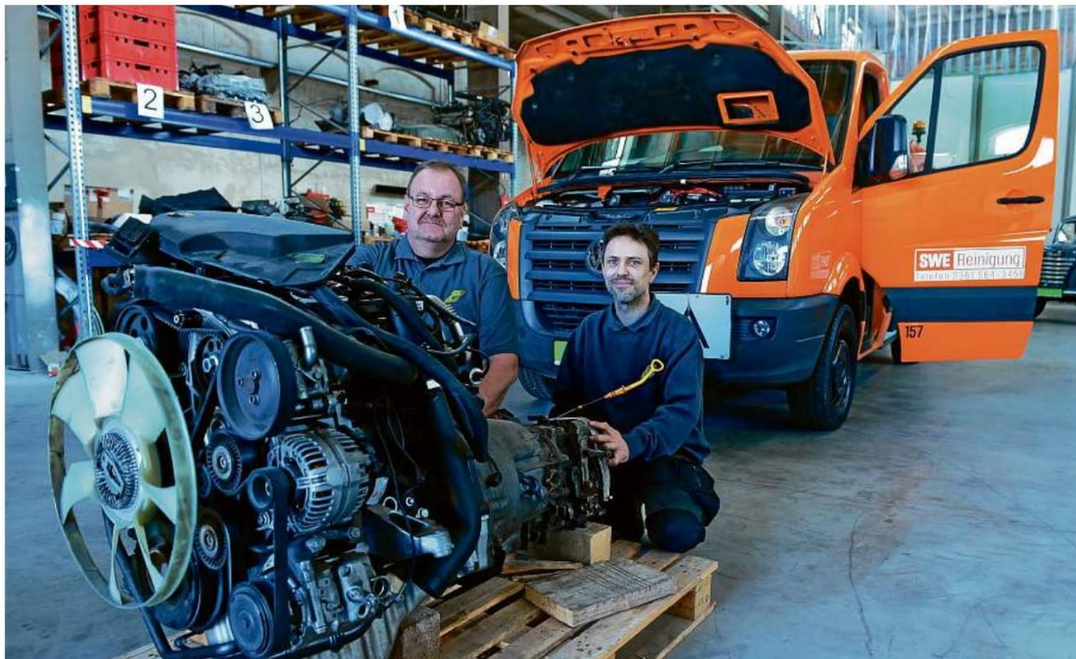
Der ausgebaute Motor samt Getriebe vor dem umgerüsteten VW: Kfz-Meister Wolfram Kutschmar (links) und Service-Techniker Enrico Graf von der Elerra GmbH haben den Diesel zum ersten elektrisch angetriebenen Müll-Entsorgungsfahrzeug der Stadtwerke Erfurt umgebaut, das demnächst Papierkörbe ansteuert.
