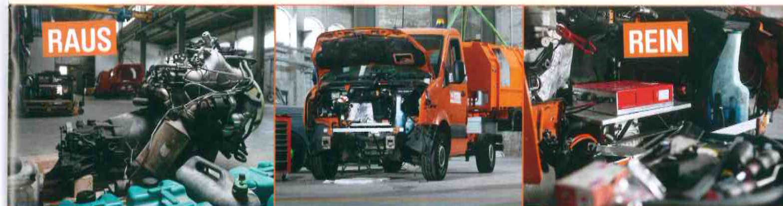
Der Dieselmotor vom VW Crafter wurde ein Ersatzteil. Kleine Kästen befinden sich nun im Motorraum und sorgen für ein emissionsloses Fahren.
