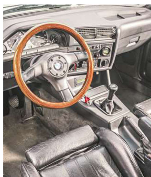
Der Dreier-BMW aus der E30-Baureihe verfügt noch über das originale Getriebe. Das Schalten muss nicht sonderlich gelernt werden: auskuppeln, dabei Strom wegnehmen, schalten, einkuppeln, Strom geben
